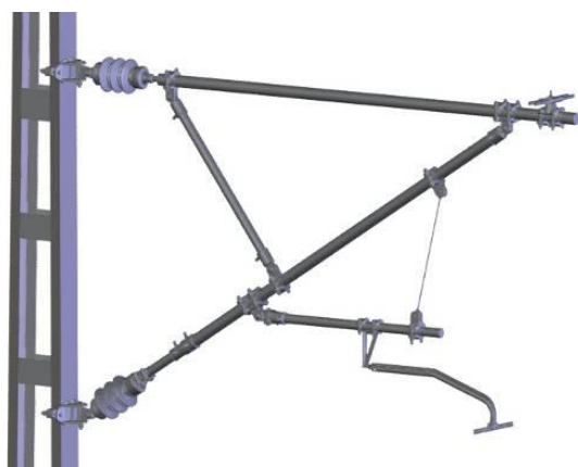
Рис. 3. Изолированная консоль на металлической опоре
